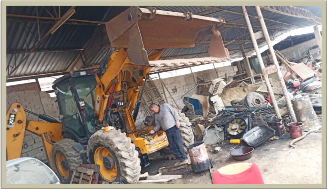
35-14-21-01 plakalı Hidromek kepçinin tırnak değişimi ve periyodik bakımları yapılmıştır.
