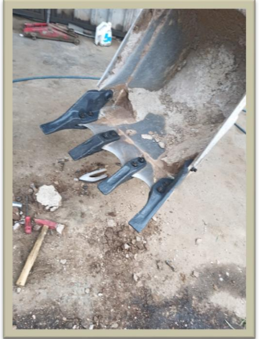
35-14-21-01 plakalı Hidromek kepçinin tırnak değişimi ve periyodik bakımları yapılmıştır.
