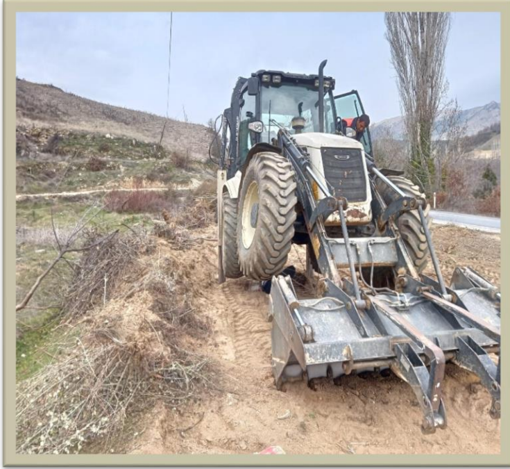
35-14-21-01 plakalı Hidromek kepçinin tırnak değişimi ve periyodik bakımları yapılmıştır.
