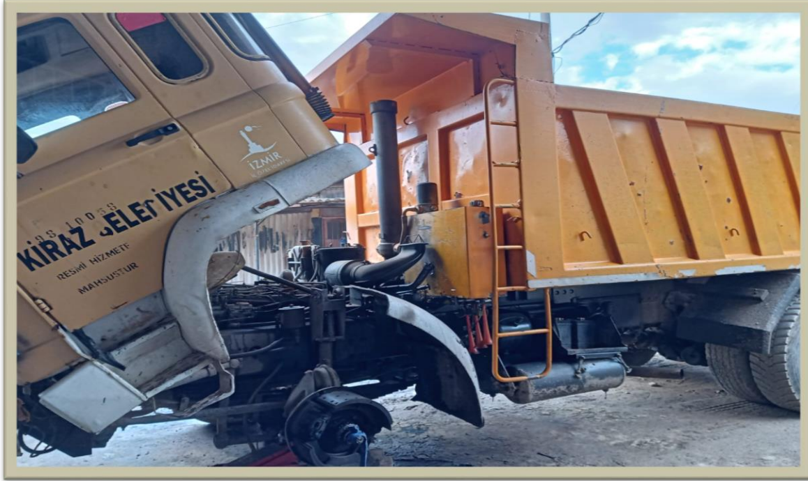
35 UE 477 plakalı Fatih aracının fren balata bakımı periyodik bakımları yapılmıştır.
